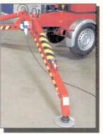
Schnelle und einfache Aufstellung mit Hydraulischen Stützbeine. Stützbeinüberwachung gehört bei allen DENKA Liften zur Standardausstattung.
